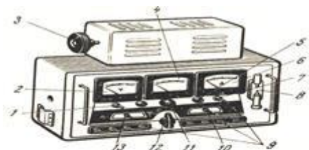
Рис. 6. Прибор для проверки электрооборудования автомобилей модели К-301:
