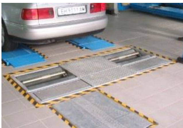
Рис.24. Стенд с беговыми барабанами
